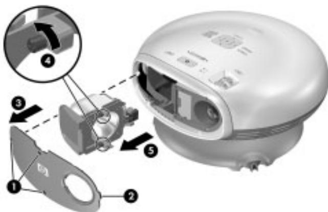
5. Insira o novo módulo da lâmpada no projetor e aperte os dois parafusos.
