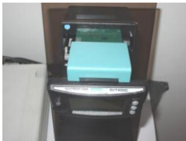
O Adaptador deverá ser inserido virado para baixo em relação ao tacógrafo.
