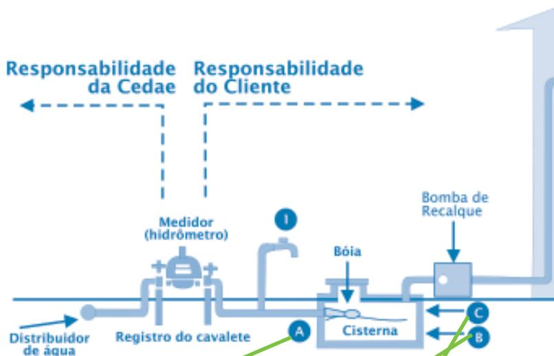
O mais comum dos vazamentos acontece no ponto A, do ramal interno. A água vaza e se infiltra no terreno e dificilmente aflora à superfície, principalmente se houver algum tipo de piso ou calçamento.
