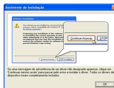
**NOTA:** Ao instalar o software para Windows XP, se uma mensagem de advertência de um driver não designado aparecer, clique em **Continue Anyway** para passar pelo aviso e instalar o driver. Todos os drivers de dispositivo foram completamente testados.
