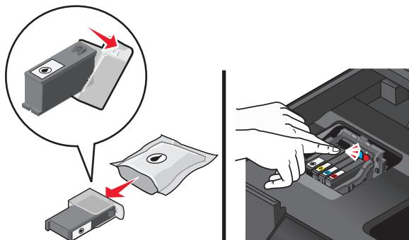
**Nota:** Instale os novos cartuchos de tinta imediatamente após remover a tampa de proteção para evitar a exposição da tinta ao ar.
