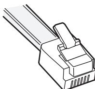
As portas de fax na parte posterior da impressora e o cabo telefônico fornecido com a impressora possuem conectores RJ-11. Se no seu país ou região o tipo de conector for diferente, pode ser necessário usar um adaptador RJ-11.
