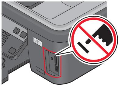
**Aviso—Dano Potencial:** não toque no cabo USB, em qualquer adaptador de rede, em qualquer conector, no dispositivo de memória ou nas áreas mostradas enquanto a impressora estiver imprimindo, lendo ou gravando do dispositivo de memória. Dados podem ser perdidos.
