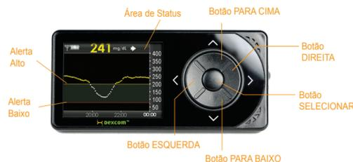
Os botões **PARA CIMA** e **PARA BAIXO** permitem a rolagem através de itens realçados e a configuração de valores. O botão **SELECIONAR** permite que você insira a opção que está realçada. O botão **ESQUERDA** permite voltar à tela ou menu anterior. O botão **DIREITA** permite avançar para a próxima seleção.
