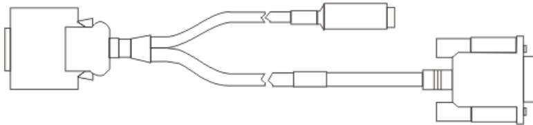
1. Segurando o conector de E/S do cabo , aperte os botões de liberação até abrir as linguetas. Conectar o cabo à porta de E/S do MX7 correspondendo o formato do conector de E/S no cabo ao formato do conector de E/S na base do MX7. Solte os botões de liberação da lingueta.
