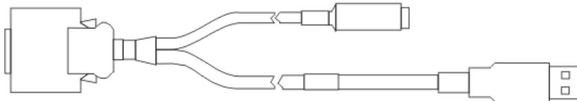
1. Segurando o conector de E/S do cabo, aperte os botões de liberação até abrir as linguetas. Conectar o cabo à porta de E/S do MX7 correspondendo o formato do conector de E/S no cabo ao formato do conector de E/S na base do MX7. Solte os botões de liberação da lingueta.
