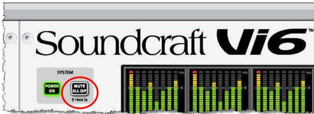
Para usar a função Silenciar Todas as Saídas, **pressione e segure** o botão “MUTE ALL O/P” (SILENCIAR TODAS SAÍDAS), localizado na adjacência com o botão “Power” (Alimentação) principal no painel dianteiro do console. O botão pisca com uma iluminação em vermelho para chamar atenção da condição de mudo.
