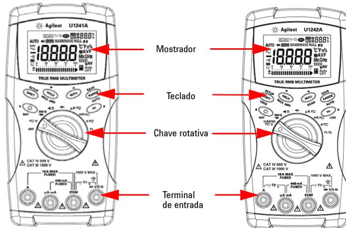
Figura 1-1 Painel frontal dos multímetros digitais portáteis U1241A e U1242A
