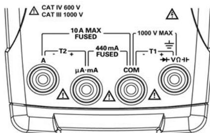
**Figura 1-5** Terminal de entrada do multímetro digital portátil U1242A
