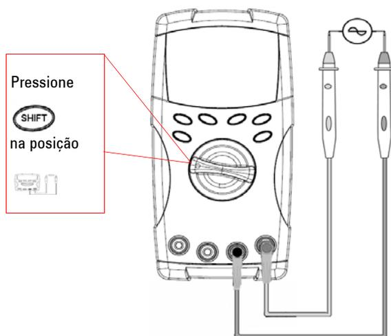
A função razão harmônica indica o desvio de formas de onda não senoidais com relação ao que seria uma forma de onda senoidal perfeita no intervalo de 0% a 100%. Uma forma de onda senoidal pura sem harmônicos daria um valor de 0,0%.
