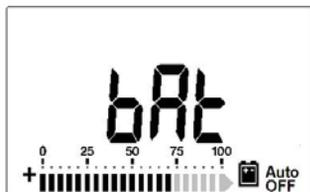
**Figura 2-3** Exibição da capacidade da bateria
