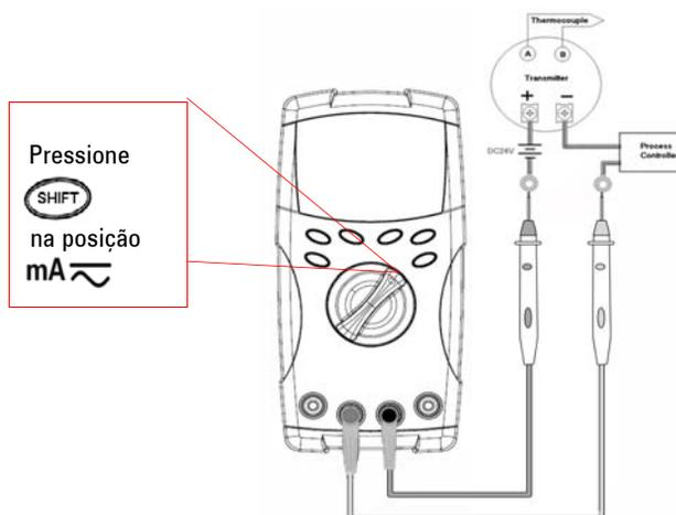
A escala % de 0 – 20 mA ou 4 – 20 mA é selecionável no modo de configuração. A escala mA% de 4-20 ou 0-20 é indicada na exibição primária e o gráfico de barras indica o valor atual. A leitura de 25% da escala representa 8 mA CC em 4 – 20mA e 5 mA CC em 0 – 20mA.
