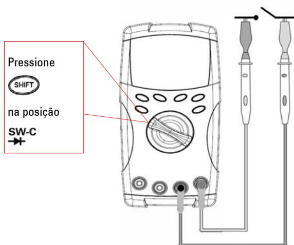
O contador de chaveamento é usado para verificar a condição de uma chave, relé ou botão de apertar. O medidor propicia uma base de tempo de 10 e 100 segundos, ou uma base de tempo definida pelo usuário.
