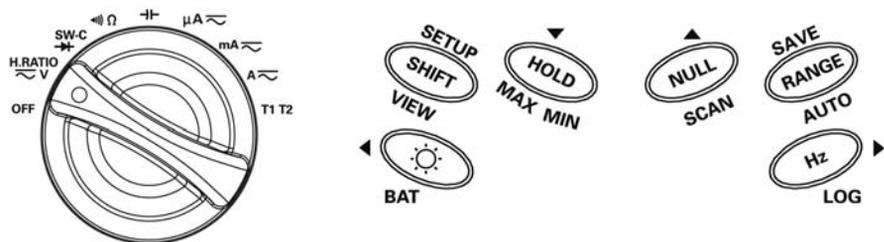
**Figura 1-4** Teclado numérico e chave rotativa do multímetro digital portátil U1242A
