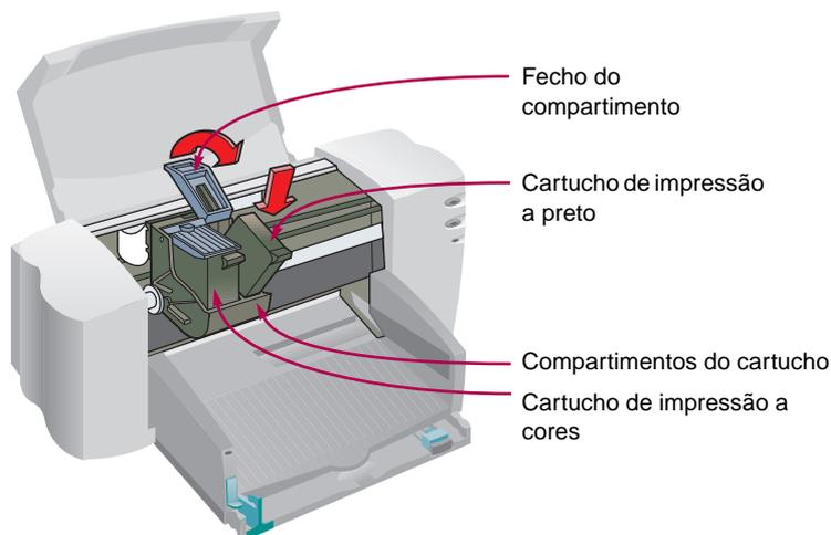
Se o Indicador luminoso do cartucho de impressão continuar piscando, remova ambos os cartuchos e coloque-os.
