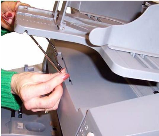
3. Ao terminar de usar a bandeja nessa posição, encaixe novamente o suporte de ajuste da altura em seu lugar original e baixe a bandeja de saída.
