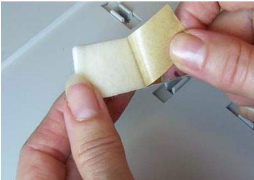
6. Alinhe a fita de absorção ao canal de transporte. Verifique se ela está devidamente alinhada antes de pressionar o lado aderente no canal.
