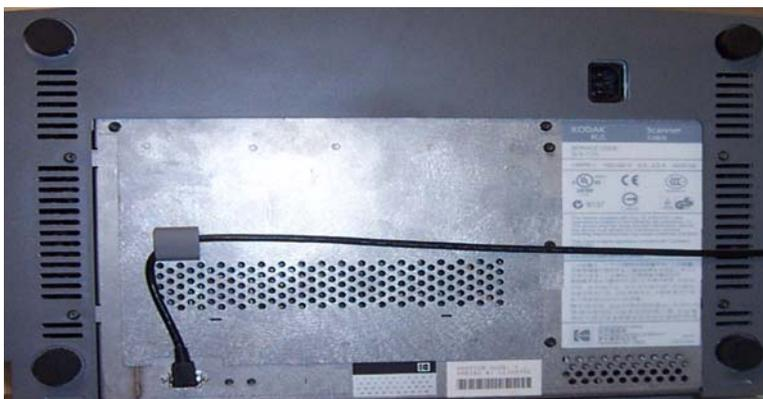
2. Conecte a outra extremidade do cabo à saída da placa IEEE-1394 no computador host. Verifique a correção e a firmeza da conexão.
