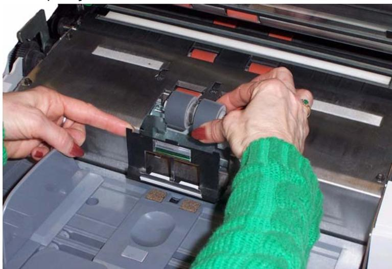
8. Gire manualmente os roletes do rolo de separação enquanto os limpa com um pano apropriado para a limpeza de rolos. Para obter os melhores resultados, passe o pano em sentido paralelo às estrias, a fim de remover possíveis resíduos entre elas.
