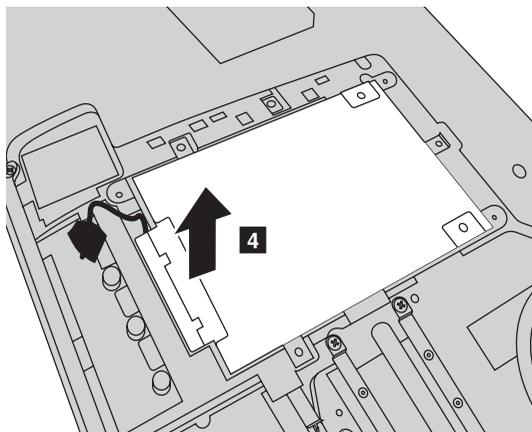
**Observação:** Certifique-se de remover o disco rígido (protegido pela estrutura de metal) com cuidado para evitar quebrar a conexão para o conector SATA.
