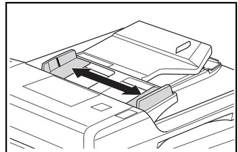
**IMPORTANTE:** Para evitar atolamentos, remova os originais restantes da *Bandeja de ejeção de originais* e ventile-os para separar as folhas antes de colocá-las.
