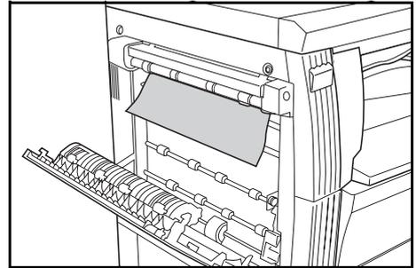
**NOTA:** Se o papel rasgar, retire todos os pedaços que ficarem soltos no interior da máquina.
