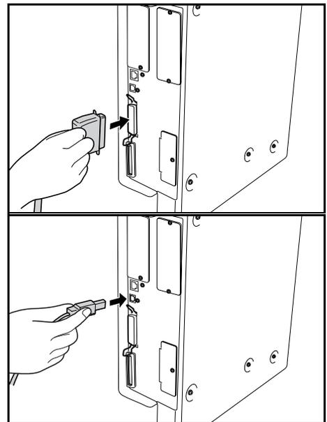
**NOTA:** Utilize um cabo USB compatível com a Revisão 2.0 de USB padrão (um plugue retangular de tipo A e um plugue quadrado de tipo B). O cabo USB deve estar protegido e não medir mais de cinco metros.
