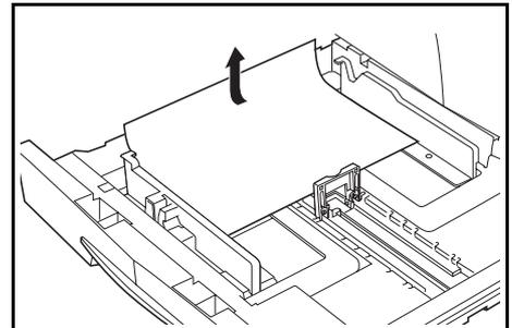
**NOTA:** Se o papel rasgar durante a remoção, retire todos os pedaços que ficarem soltos no interior da máquina.
