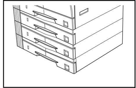
**NOTA:** Podem ser adicionados até três cassetes no modelo de 16 ppm e até dois nos modelos de 20 ppm e de 25 ppm.
