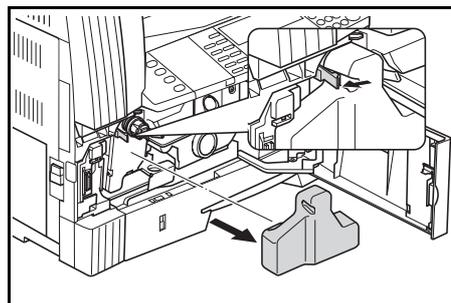
**3** Utilize a tampa fixada no centro da *Caixa de toner* para cobrir a abertura e evitar que o toner continue gotejando.
