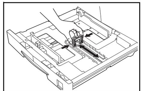
Ao colocar papel A3 ou 11 × 17" (Duplo carta), leve a guia de comprimento do papel para a extremidade direita e empurre-a para baixo, conforme a figura.
