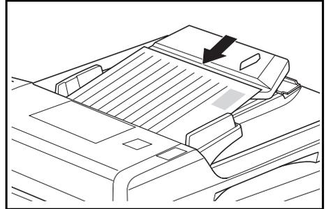
**IMPORTANTE:** Para evitar atolamentos, assegure-se de que os originais não excedam o indicador de nível no interior da guia de inserção traseira.
