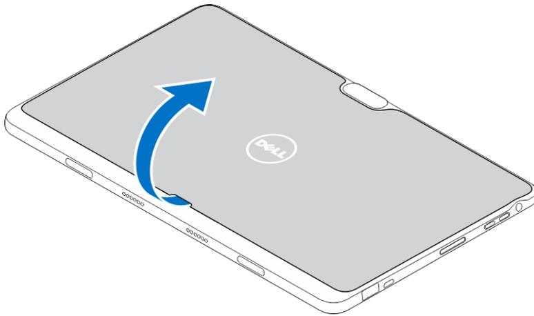
3. Deslize a trava de liberação para desbloquear a bateria. Levante e remova a bateria do tablet.
