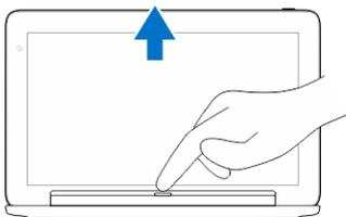
2. Levante o tablet do acoplamento do teclado móvel.
