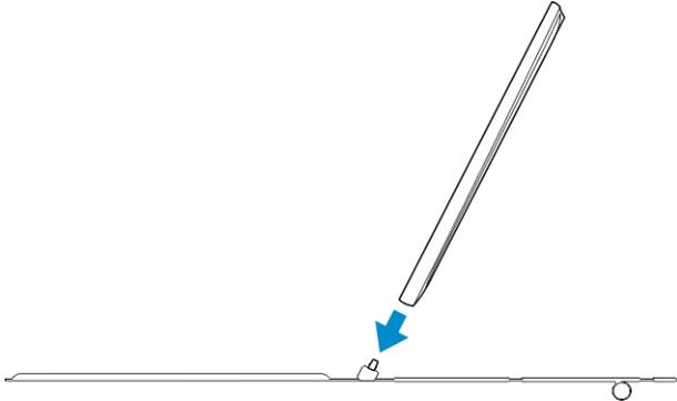
3. Conecte a tampa do teclado e deslize-a para baixo para fixar a ancoragem no tablet.
