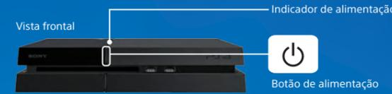
Se o vídeo não for exibido na tela ou o vídeo não for exibido corretamente ao ligar o sistema (o indicador de alimentação acende na cor branca), toque no botão (alimentação) por, pelo menos, 7 segundos (até que o sistema emita o segundo bipe) para desligá-lo e depois ligue-o novamente.
