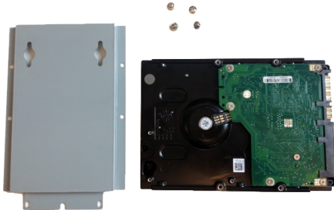
Figura 11: Disco rígido removido da placa base.
