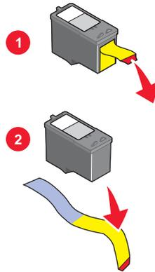
**Aviso:** não toque na área de contato dourada na parte traseira nem nos orifícios de metal na parte inferior dos cartuchos.
