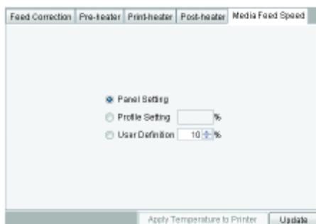
Se a Velocidade de Alimentação do Material de Trabalho, configurada como padrão, não fizer corretamente a alimentação, ajuste o valor de 'Media Feed Speed'.
