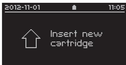
Se nenhum cartucho for inserido em 30 segundos, a porta do compartimento do cartucho será fechada automaticamente e o visor voltará para a janela «Run test»
