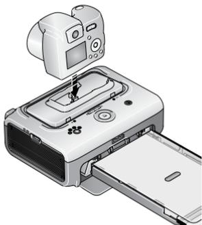
**2** Coloque a câmera na estação impressora. Empurre para baixo para encaixar o conector.
