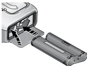
3 Deslize o cartucho colorido para a posição, com a etiqueta virada para cima e a seta apontando em direção à estação impressora. Empurre o cartucho até que se encaixe na posição com um "clique".
