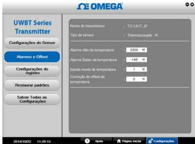
Figura 6-9. Tela de alarmes termopar e offset
