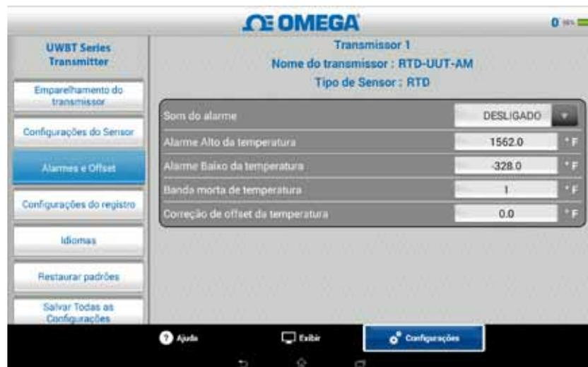
Figura 5-42. Banda morta de temperatura de 1°F
