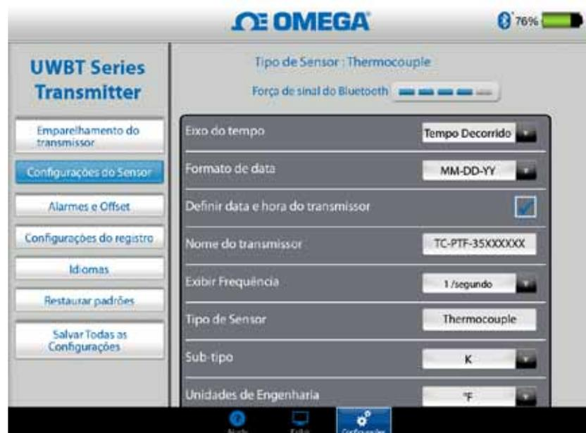
Figura 4-34. Alterando o nome do transmissor
