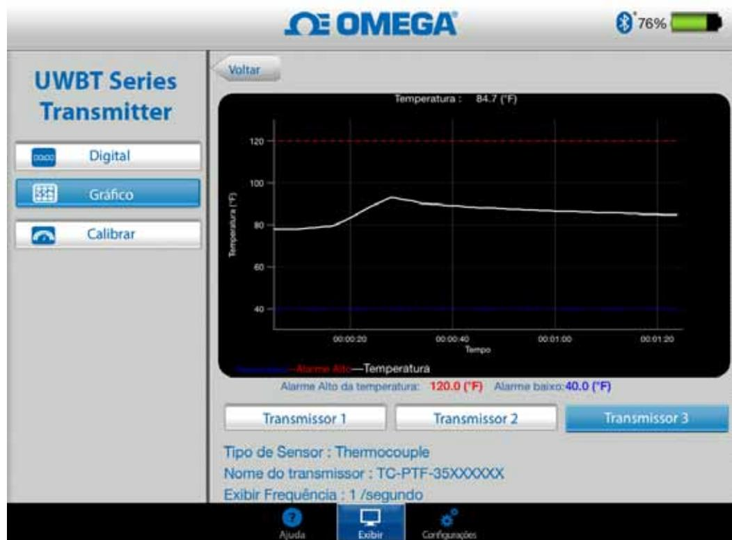
Figura 4-7. Gráfico de temperatura ao vivo com alarmes para alta e baixa
