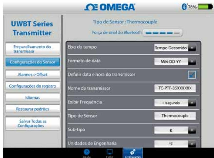
Figura 4-33. Configurações de data e hora do dispositivo
