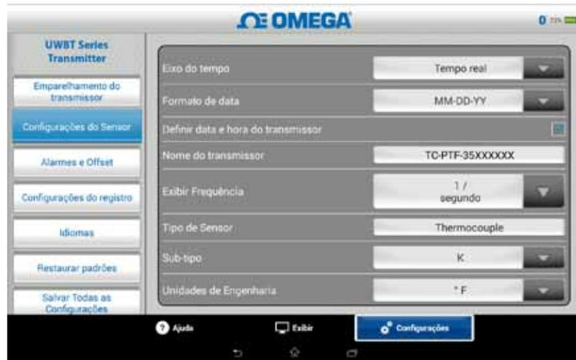
Figura 5-34. Visualizando tipo de sensor e subtipo para sensor termopar
