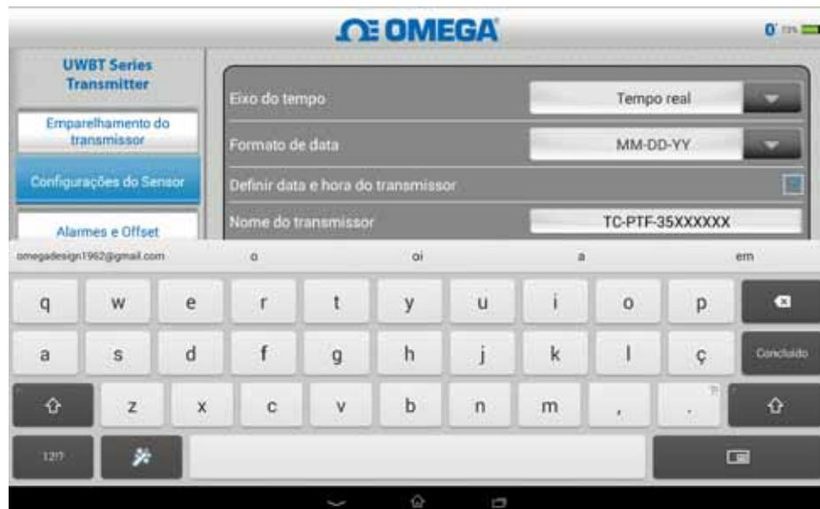
Figura 5-33. Alterando o nome do transmissor
