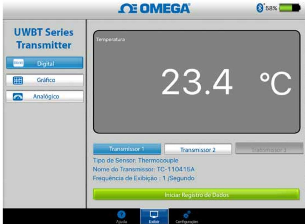
Figura 4-6. Visor de temperatura digital
