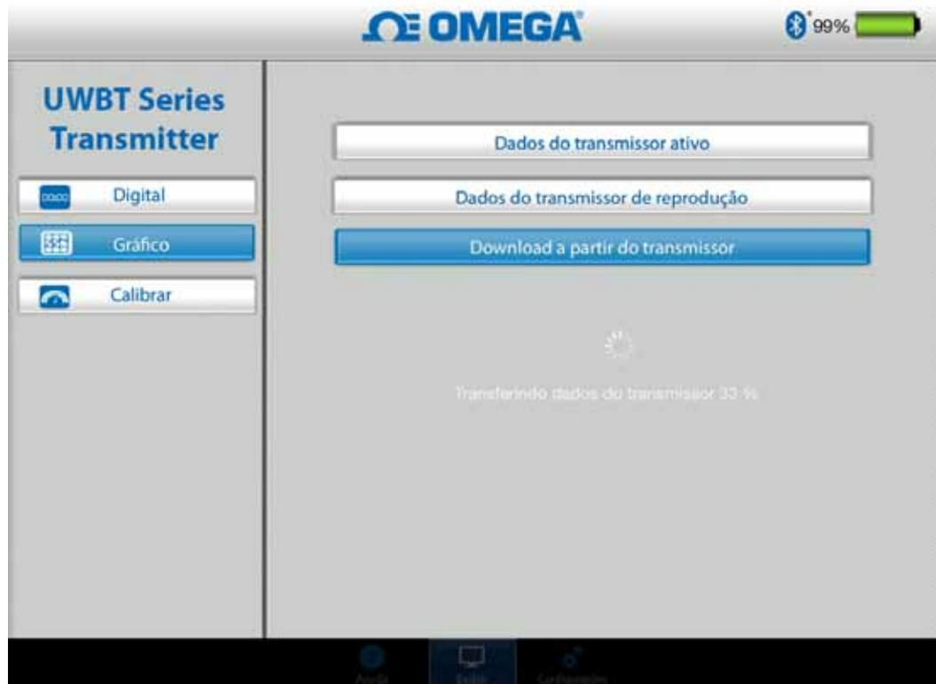
Figura 4-11. Baixando arquivos de registro do transmissor
