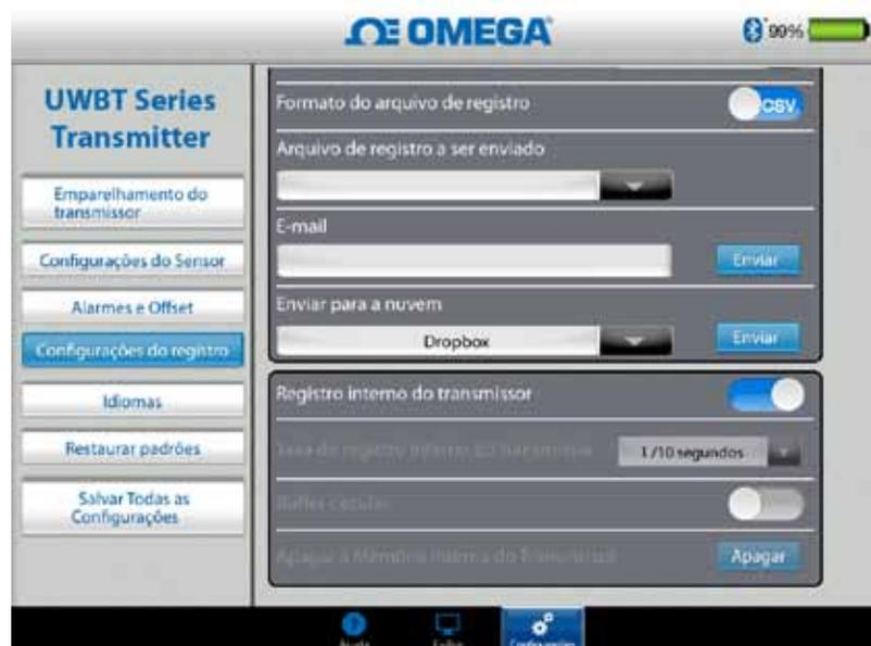
Figura 4-24A. Opções de registro interno (desativadas quando Registro interno estiver ativado)
