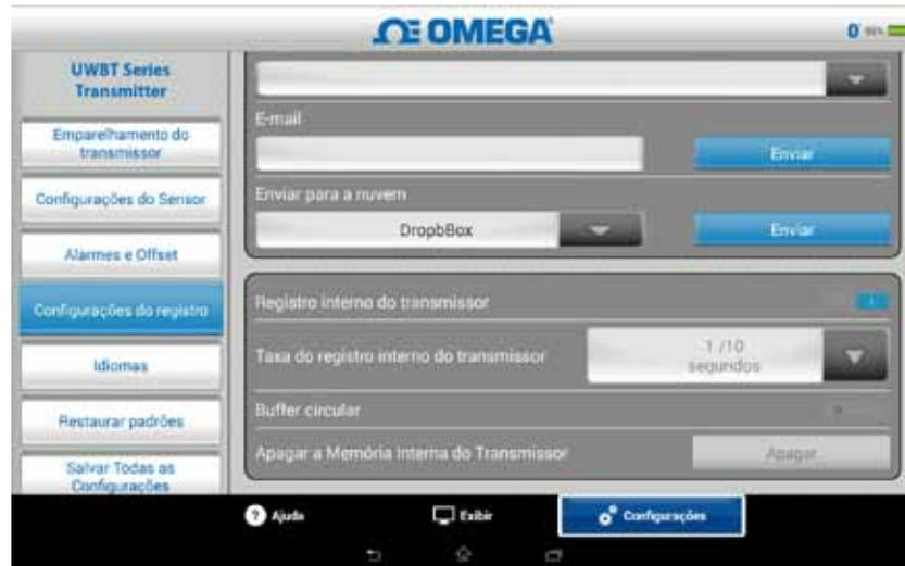
Figura 5-23A. Opções de registro interno (desativadas quando Registro interno estiver ativado)
