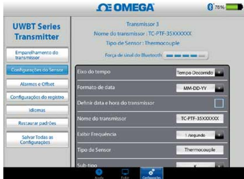
Figura 4-28. Tela de configurações do sensor termopar
