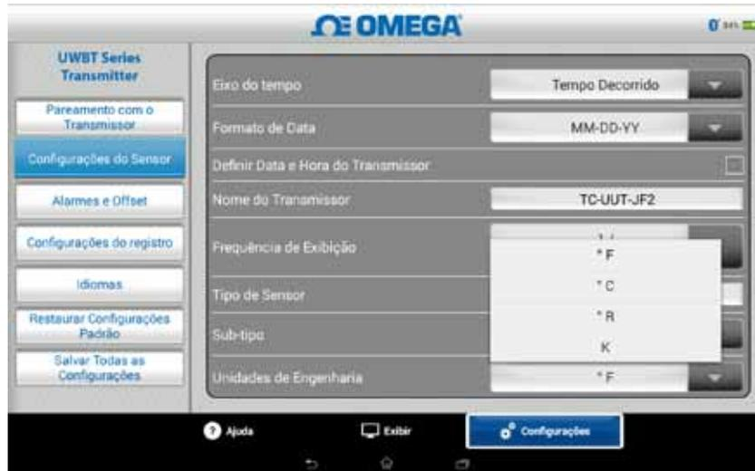
Figura 5-37. Configurando as unidades de temperatura
