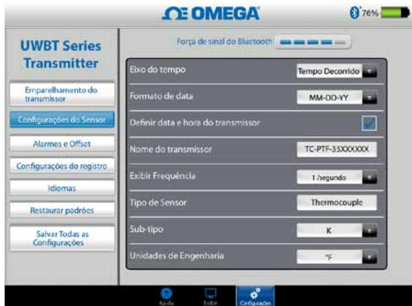
Figura 4-35. Visualizando tipo de sensor e subtipo para sensor termopar
