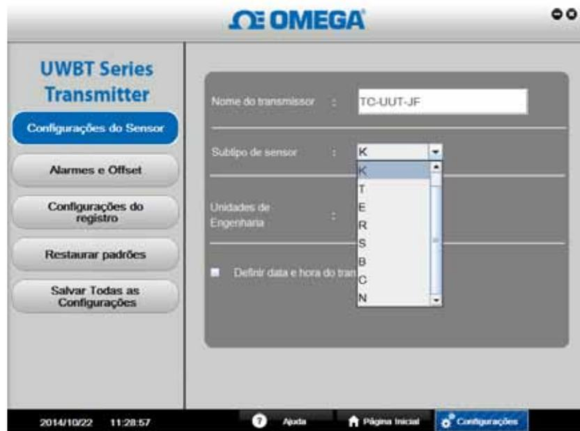
Figura 6-8. Tela de configurações do sensor termopar
