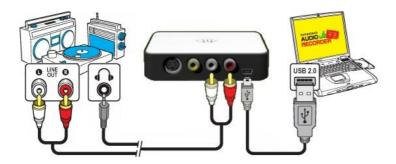
As conexões do reprodutor de áudio podem ser feitas através de cabos RCA (Compostos) ou com um cabo adaptador de fone de ouvido para adaptador RCA (Composto).
