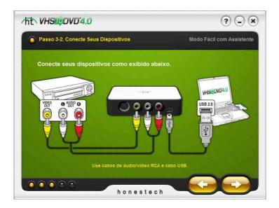
\*As conexões de cabo RCA (Composto) são exibidas aqui. As conexões de S-Vídeo diferem ligeiramente, mas serão totalmente ilustradas se o S-Vídeo for selecionado como o tipo de conexão na etapa 3-1.
