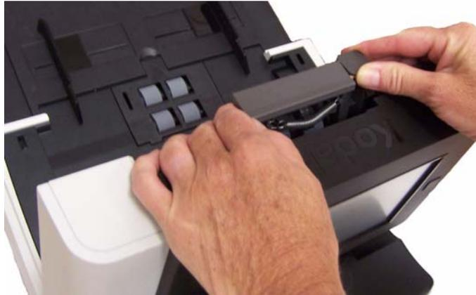
2. Gire manualmente e limpe os roletes do módulo de separação com um pano apropriado para limpeza de rolos.
