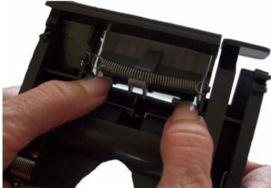
3. Empurre as guias para baixo até que a base de pré-separação surjam na parte frontal do módulo de separação.
