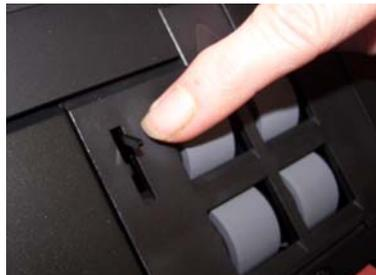
1. Empurre a saliência da tampa do módulo de alimentação, puxando-a para cima e para fora, a fim de removê-la.
