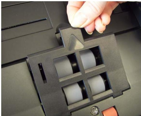
2. Gire o módulo de alimentação para frente e empurre-o para a esquerda para removê-lo.
