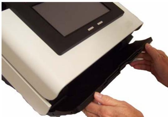
2. Pressione e mantenha pressionado a alavanca de liberação da tampa do Scan Station e puxe a tampa do Scan Station para abrir.
