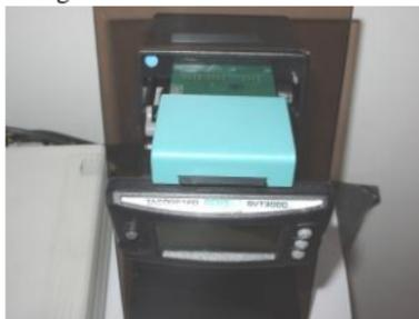
O Adaptador deverá ser inserido virado para baixo em relação ao tacógrafo.
