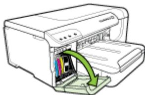
2. Remova o cartucho de tinta que deve ser substituído, segurando-o com o polegar e o indicador e puxando-o com firmeza em sua direção.
