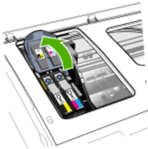
4. Levante a alça do cabeçote de impressão e use-a para puxar o cabeçote para fora do slot.
