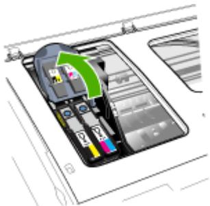
5. Levante a alça do cabeçote de impressão e use-a para puxar o cabeçote para fora do slot.
