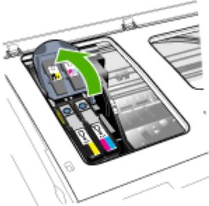
5. Levante a alça do cabeçote de impressão que deseja substituir e retire-o de seu slot.
