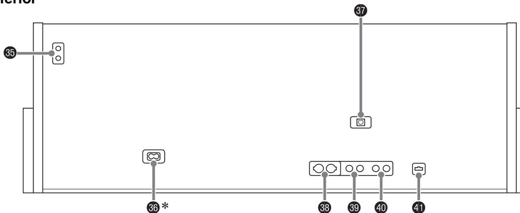
\* Com o AP-620BK e AP-6BP, o cabo de alimentação é conectado permanentemente ao Piano Digital.
