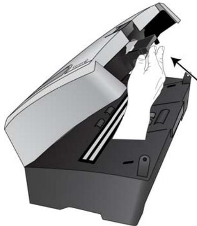
3. Pressione o compartimento do rolamento até que ele se encaixe na tampa do scanner.
