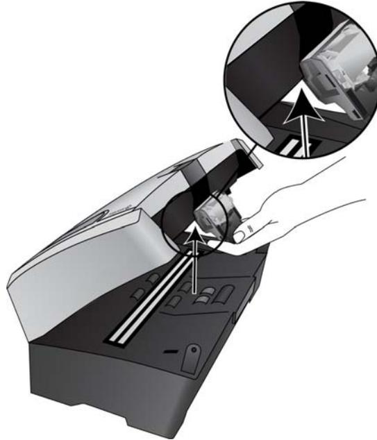
2. Incline o compartimento para cima e para dentro do scanner.
