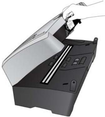
5. Com firmeza, puxe o compartimento do rolamento em sua direção. Você ouvirá ele se soltando da tampa da scanner.
