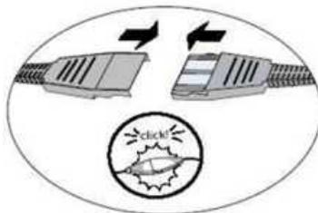
3. Deslize as extremidades do cabo para uni-las até ouvir um clique. Não gire nem dobre os conectores. O microfone e o alto-falante internos do Thor VM1 são desativados automaticamente.
