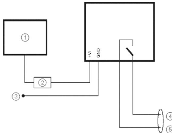
1. Circuito de movimento - A tensão na entrada + Vi na caixa de supressão de tela deve estar entre 60 ou 10VCC e 72VCC (ver etiqueta da caixa de supressão de tela), quando o veículo estiver em movimento e menos de 5 VCC quando o veículo não estiver em movimento.
