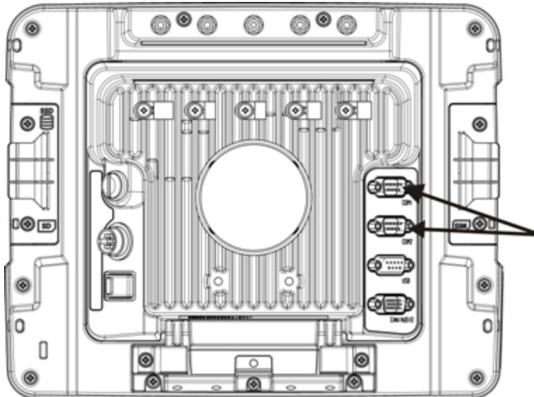
1. Assente o conector da extremidade do cabo firmemente na porta COM serial na na plataforma inteligente de montagem rápida .
