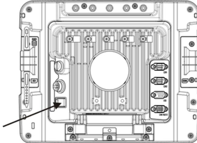
O lado "On" deste interruptor tem uma elevação para permitir que o estado do interruptor seja determinado quando o interruptor não pode ser facilmente visualizado, por exemplo, após a plataforma estar montada num veículo.
