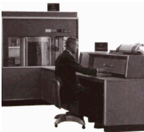
Figura 7 – O primeiro *hard disk* – o IBM 305 RAMAC
