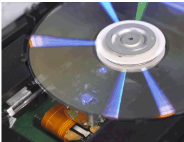
Figura 9 – Leitor óptico que utiliza um laser azul para ler um disco Blu-ray de 50 GB.
