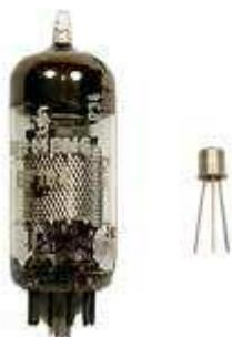
Figura 6 – Comparação entre uma válvula electrónica, utilizada entre as décadas de 1940 e 1960, e um transistor, surgido no mercado na década de 1950.
