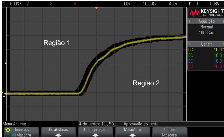
Até oito regiões podem ser definidas para uma máscara. Elas podem ser numeradas de 1 a 8, e aparecer em qualquer ordem no arquivo .msk. A numeração das regiões deve ir de cima para baixo, da esquerda para a direita.
