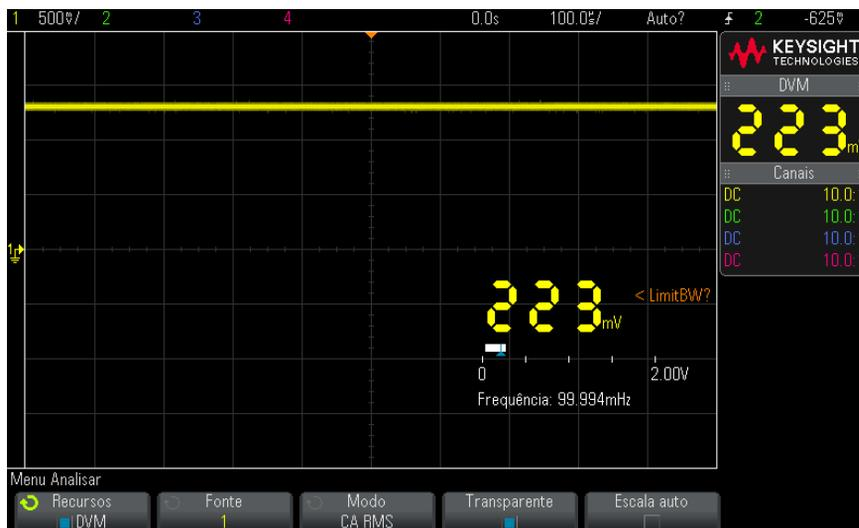
O DVM faz medições RMS precisas quando a frequência do sinal está entre 20 Hz e 100 kHz. Quando a frequência do sinal não está nesta faixa, o texto "<LimitBW?" o ">LimitBW?" aparece na exibição do DVM para alertar sobre resultados imprecisos de medição RMS.
