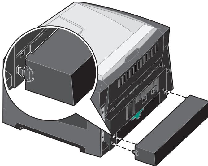
Conecte uma tampa contra poeira opcional na parte traseira da impressora, alinhando as guias da tampa com os furos da impressora, e *encaixe* a tampa.
