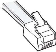
As portas de fax na parte posterior da impressora e o cabo telefônico fornecido com a impressora possuem conectores RJ-11. Se no seu país ou região o tipo de conector for diferente, pode ser necessário usar um adaptador RJ-11.
