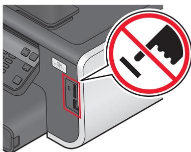
**Aviso—Dano Potencial:** não toque em qualquer cabo, adaptador de rede, cartão de memória, no adaptador USB Bluetooth ou na área mostrada da impressora enquanto ela estiver imprimindo, lendo ou gravando a partir de um dispositivo compatível com Bluetooth. Dados podem ser perdidos.
