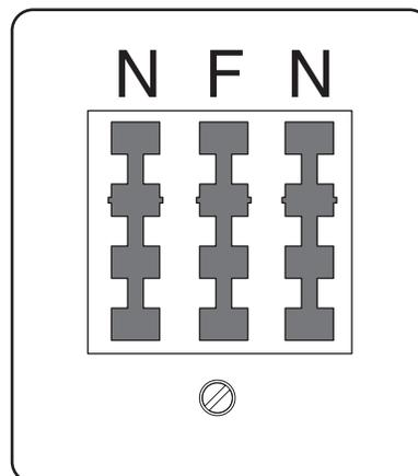
Conecte a impressora a qualquer uma das portas N.
