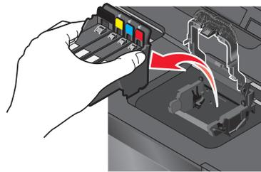
3 Limpe os contatos do cabeçote de impressão usando um pano limpo e sem fiapos.
