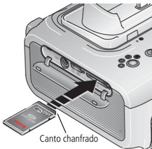
2 Coloque o cartão Kodak Wi-Fi® no sentido indicado e empurre-o no slot para cartão para encaixar o conector.
