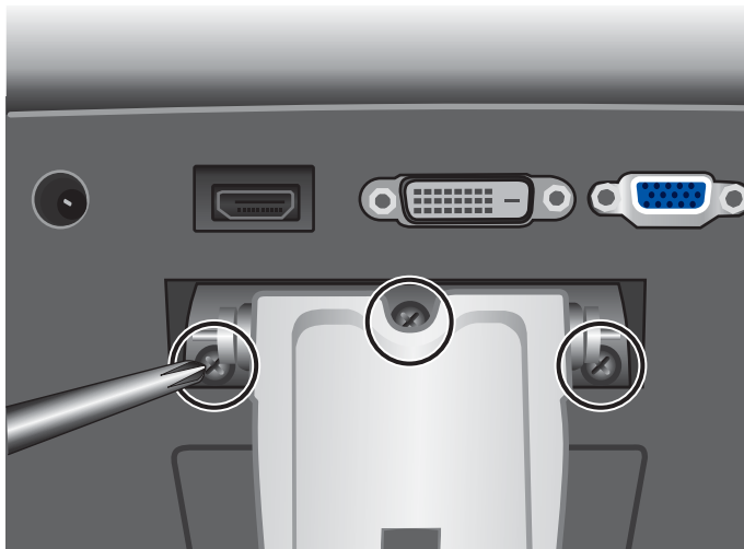
Figura 3-12 Remoção dos Parafusos da Dobradiça
