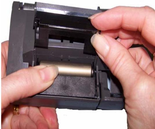
5. Retire a base de pré-separação usada.
