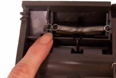
3. Levante a mola do suporte e mova-a para a esquerda ou para a direita conforme desejado para ajustar a tensão.
