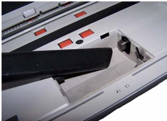
6. Reinstale o módulo de alimentação alinhando os pinos e empurrando-o para a esquerda, a fim que se encaixe em sua posição. Certifique-se de que as engrenagens estejam alinhadas e de que ele esteja devidamente encaixado. Role o módulo de alimentação de volta para o lugar.
