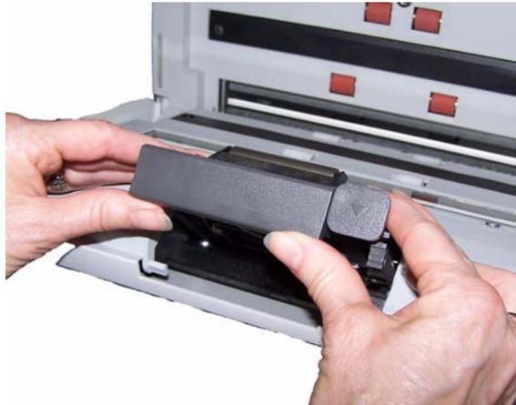
2. Gire manualmente e limpe os roletes do módulo de separação com um pano apropriado para limpeza de rolos.
