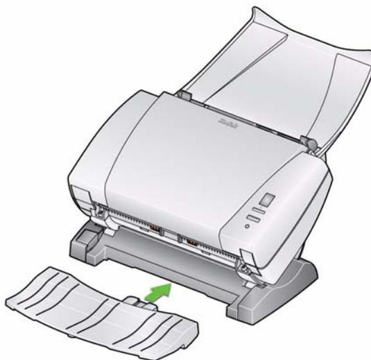
4. Instale o clipe deslizando-o para o scanner entre os compartimentos da parte central e encaixe-o no local.
