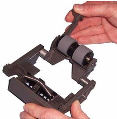
3. Remova o rolo de separação da estrutura do módulo de separação.
