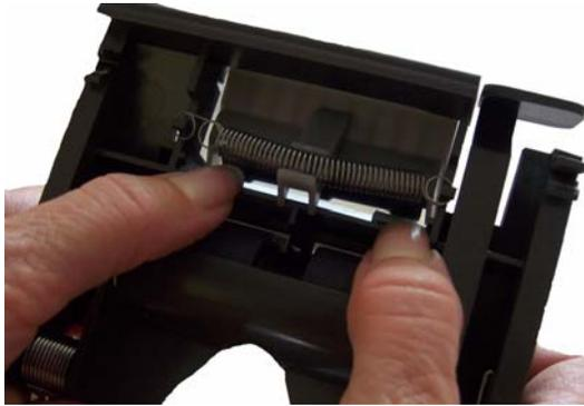
3. Empurre as guias laterais para baixo até que a base de pré-separação surjam na parte frontal do módulo de separação.
