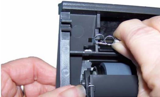
4. Ao terminar, reinsira o módulo de separação alinhando as guias aos slots e encaixando-o na posição.
