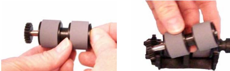
7. Repita o procedimento acima para substituição dos roletes do outro suporte.
