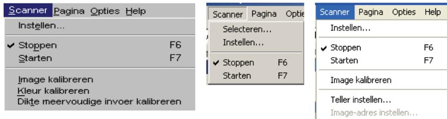
**Selecionar** — acessa a caixa de diálogo Selecionar, que permite a escolher o scanner que deve ser usado. Isso é necessário quando há mais de um scanner conectado ao PC host ou quando o modo de execução é o de emulação. Consulte no apêndice apropriado sobre scanner os procedimentos para selecionar um scanner.
