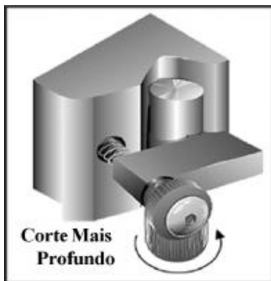
Figura 11. Girar o pé para aumentar a exposição da lâmina.
