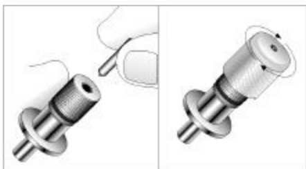
Figuras 8. Instalação da Lâmina e do Pé da Lâmina no Suporte
