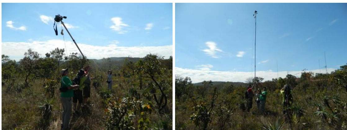
Figuras 3 e 4: Procedimento de tomadas de fotografias no ponto 1 da trilha. Equipamento utilizado: Bastão de alumínio com uma câmera fotográfica e controle remoto.
