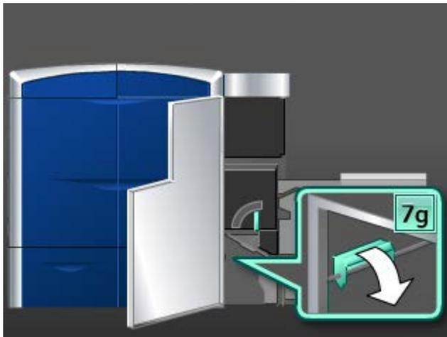
3. Use um pano sem fiapos e umedecido com água (não molhado) para limpar o trajeto do papel somente nas áreas de eliminação de atolamentos da alavanca verde, conforme exibido na ilustração.
