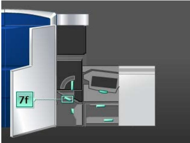
6. Use um pano sem fiapos e umedecido com água (não molhado) para limpar o trajeto do papel somente nas áreas de eliminação de atolamentos da alavanca verde, conforme exibido na ilustração.
