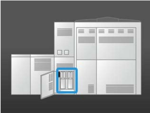
Quando um frasco de toner usado fica cheio, é exibida uma mensagem na interface com o usuário informando o momento em que o frasco deve ser substituído. Como há um segundo frasco de toner usado, a máquina continuará a funcionar enquanto esse segundo frasco de toner usado não ficar cheio. Isso permite que você troque o frasco cheio por um vazio enquanto a máquina continua a impressão.
