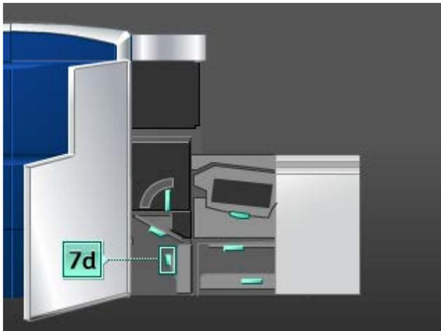
9. Use um pano sem fiapos e umedecido com água (não molhado) para limpar o trajeto do papel somente nas áreas de eliminação de atolamentos da alavanca verde, conforme exibido na ilustração.
