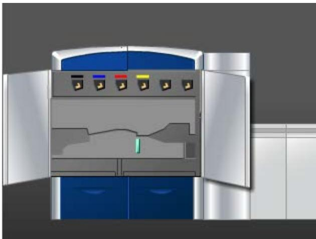
2. Use um pano sem fiapos e umedecido com água (não molhado) para limpar o trajeto do papel somente nas áreas de eliminação de atolamentos da alavanca verde, conforme exibido na ilustração.
