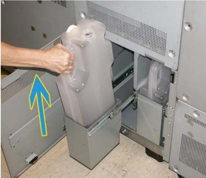
4. Remova a tampa do suporte de tampa na lateral do frasco cheio e pressione a tampa com firmeza no orifício aberto na parte superior do frasco cheio.
