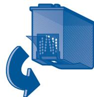
**Cuidado!** Para evitar obstruções, falha de tinta e conexões elétricas defeituosas, não toque nos bicos injetores de tinta do cartucho de tinta ou nos contatos de cobre e não remova as fitas de cobre.
