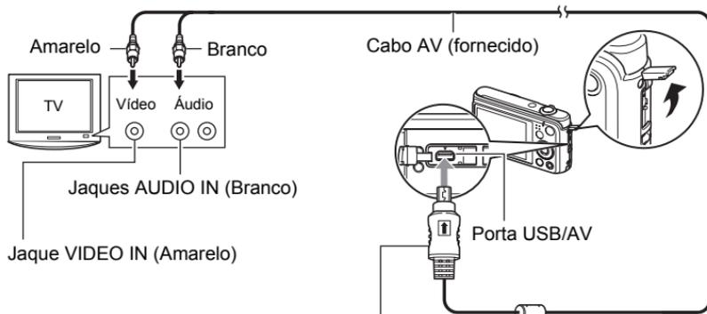
Certifique-se de que a marca ▼ na câmera esteja alinhada com a marca ▲ no conector do cabo AV e, em seguida, conecte o cabo à câmera.
