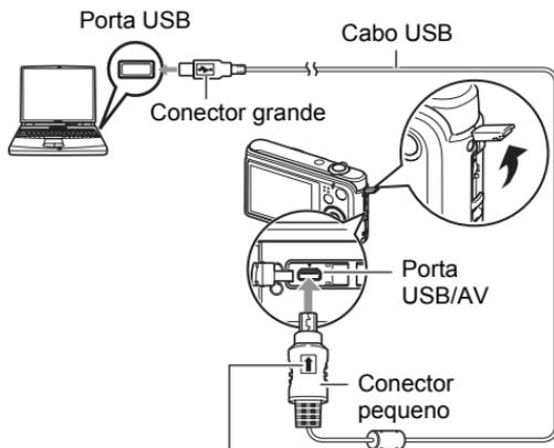
Certifique-se de que a marca ▼ na câmera esteja alinhada com a marca ▲ no conector do cabo USB e, em seguida, conecte o cabo à câmera.
