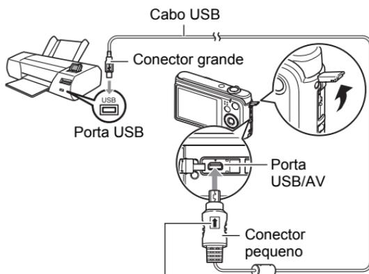
Certifique-se de que a marca ▼ na câmera esteja alinhada com a marca ▲ no conector do cabo USB e, em seguida, conecte o cabo à câmera.
