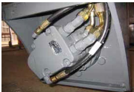
Motores de roda dianteiro e traseiro esquerdo
