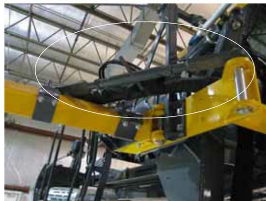
Instalação da barra com catraca
