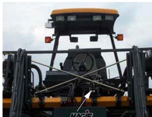
Válvula da retração hidráulica
