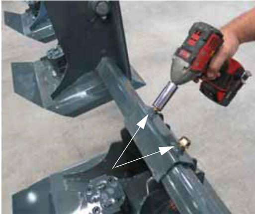
Parafusos de cabeça de cortador
