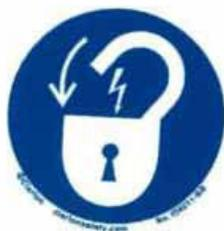
Identifica que o circuito elétrico pode ser rompido, evitando que o trator dê partida quando a chave de ignição estiver na posição OFF.
