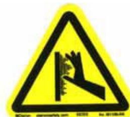
Alerta o operador que o cano de escapamento pode estar suficientemente quente para causar queimadura. Evite tocar no cano do escapamento enquanto o trator estiver funcionando. Deixe o motor esfriar suficientemente, antes de executar quaisquer procedimentos de serviço ou manutenção.
