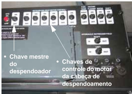
Chaves mestre do despendoador e do controle do motor de cabeça de despendoamento (Localizadas no console lateral)
