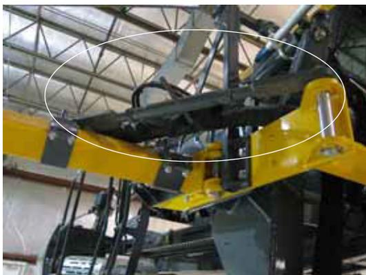
Instalação da barra com catraca
