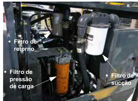
Filtros de sucção, de pressão de carga e de retorno
