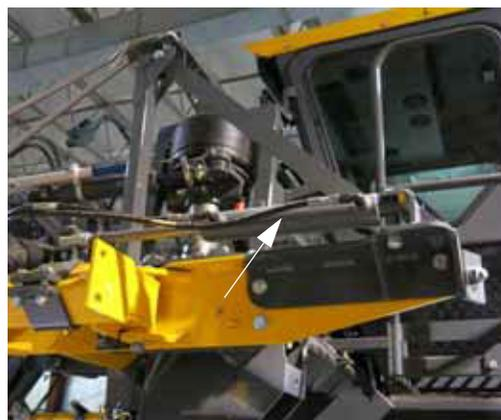
Cilindro da retração hidráulica
