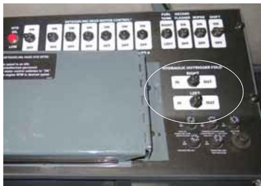
Chaves do estabilizador hidráulico retrátil
