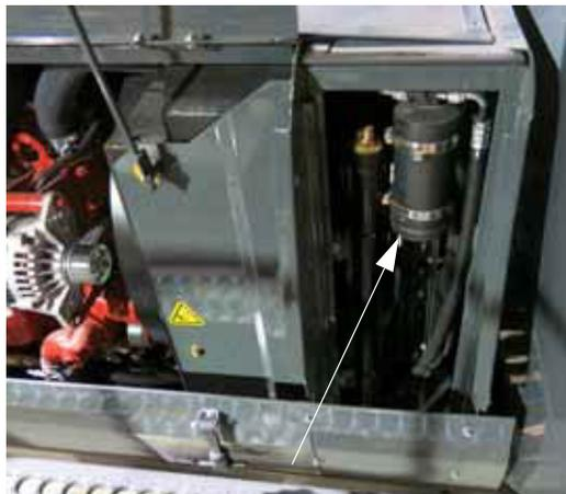
Receptor/Secador do sistema de A/C
