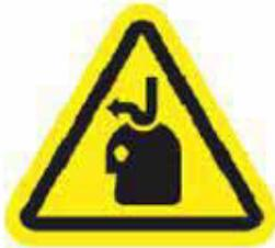
Alerta o operador do risco de bater sua cabeça ao entrar na estação do operador.
