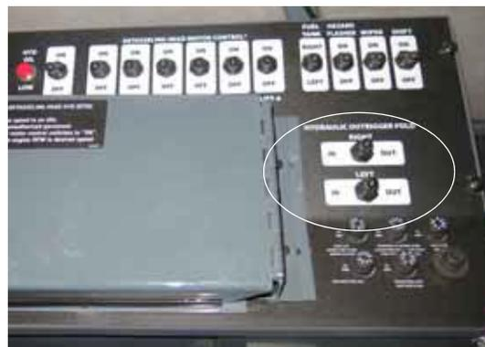
Chaves do estabilizador hidráulico retrátil
