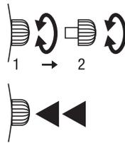
La couronne fait également office de poussoir pour différentes fonctions telles que l'activation ou la désactivation de l'alarme et pour les trois fonctions du chronographe: démarrage, arrêt et remise à zéro.
