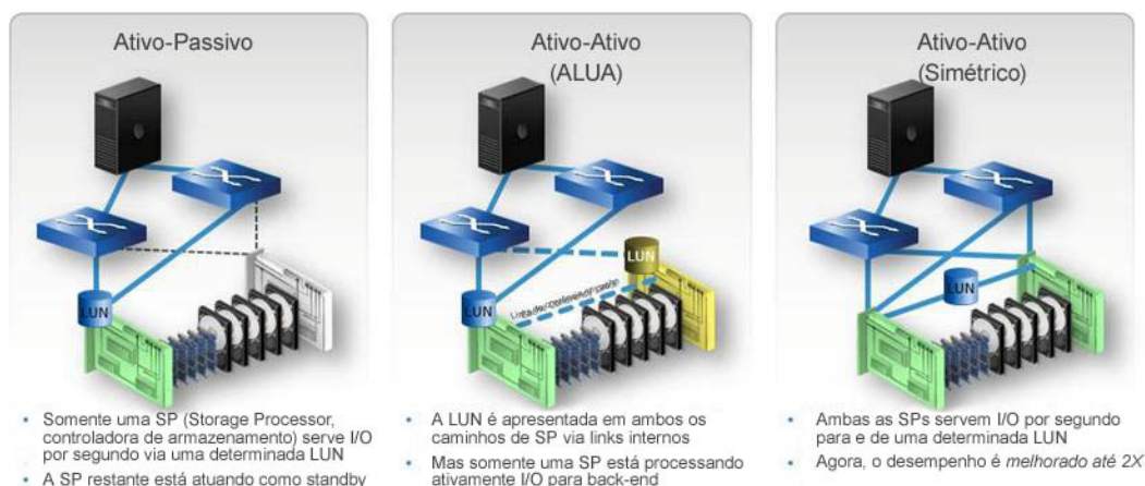
Figura 4. Processadores ativo/ativo aumentam o desempenho, a capacidade de recuperação e a eficiência.
