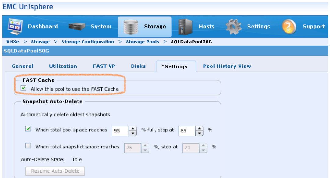
Figura 7. Propriedades do pool de armazenamento – FAST Cache habilitado
