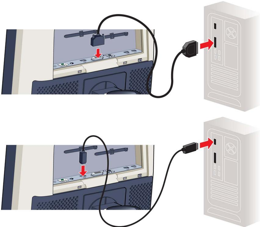
2. Caso deseje utilizar o conector USB upstream do monitor, conecte um conector USB upstream do computador no conector USB downstream do monitor.
