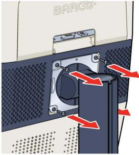
6. Conecte o braço **firmemente** ao painel com os quatro parafusos M4 x 8 mm.
