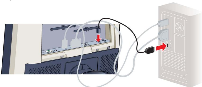
3. Caso tenha optado por utilizar o conector USB downstream do monitor, conecte um dispositivo USB ao conector downstream.
