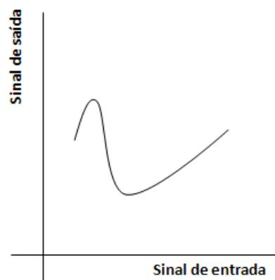
**Figura 2:** Distorção não linear. Fonte: arquivo pessoal
