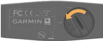
**2** Use uma moeda para rodar a tampa para a esquerda até poder ser removida (a seta aponta para **OPEN**).
