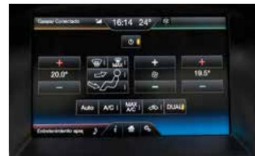
**Nota:** É possível ajustar as temperaturas do lado do motorista e do lado do passageiro independentemente com uma diferença de temperatura de até 4°C.
