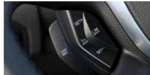
Para ativar, aperte o botão **LIM** e, em seguida, aperte o botão de **SET+** até definir a velocidade desejada, que é apresentada na tela do computador de bordo no Painel de Instrumentos. Essa função será habilitada para velocidades superiores a 30km/h.
