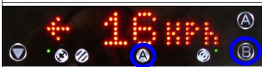
Após marcado o ponto “A”, o ícone de ponto “A” aparece indicando esta condição e o botão “B” começa a piscar, aguardando a marcação deste novo ponto.
