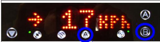
Após marcado o ponto “A”, o ícone de ponto “A” aparece indicando esta condição e o botão “B” começa a piscar, aguardando a marcação deste novo ponto.
